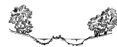
Dévégétalisation et scarification de l'atterrissement
