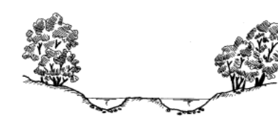
Arasement au niveau des basses eaux et enlèvement des matériaux
